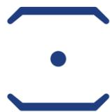
Con la cottura tradizionale vengono accese la **resistenza inferiore e la resistenza superiore** del forno. Questo metodo di cottura è ideale per cibi che necessitano della conservazione di un certo livello di umidità come arrostiti e pesce.
