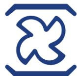
Gli elementi riscaldanti superiori e inferiori funzionano con l'ausilio di una ventola interna al forno. **L'uso della ventola garantisce la distribuzione del calore** sull'intera superficie del cibo ed è particolarmente adatta per la preparazione di pizza, focaccia, pane, ecc...
