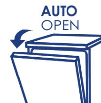
**Smart door** è la funzione che fa aprire automaticamente la porta a fine ciclo. Questo aiuta a far asciugare più rapidamente le stoviglie e a **migliorare l'efficienza energetica** massimizzando le prestazioni di asciugatura in **classe A+++ -10%**.
